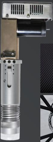
**IECHO EOT** 通过伺服马达驱动刀片上下高频振动从而切断材料，非常适合切割中等密度的材料，搭配种类繁多的刀片可以胜任绝大部分柔性材料的切割。
