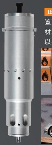
**IECHO KCT** 主要用于乙烯基材料的切割，通过调节刀尖位置可以对材料进行精准的深度定位加工，准确的切透上层材料并且不破坏下层的底衬材料。与UCT工具一样可以允许以其最快的加工速度对材料进行切割加工。
