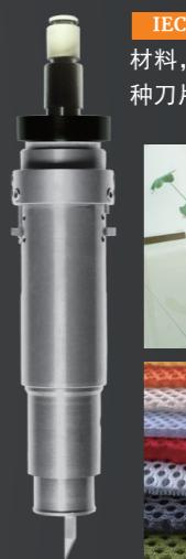
**IECHO POT** 通过压缩空气驱动刀片上下高频振动从而切断材料，最高8mm振幅特别适合切割坚韧、致密的材料，配合特种刀片切割厚度高达60mm。
