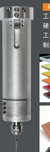
**IECHO RZ** 通过高速旋转一个或多个刀齿进行铣削加工的工具，最高转速60000/分钟，切割边缘更加光滑除了可以对硬质材料进行加工，甚至也可以对软性的发泡材料进行加工，与Kiss-Cut工具一样可以进行精准的深度定位加工。特制的吸尘装置，在加工过程中大量减少产生的碎屑。
