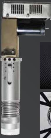
**IECHO EOT** 通过伺服马达驱动刀片上下高频振动从而切断材料，非常适合切割中等密度的材料，搭配种类繁多的刀片可以胜任绝大部分柔性材料的切割。
